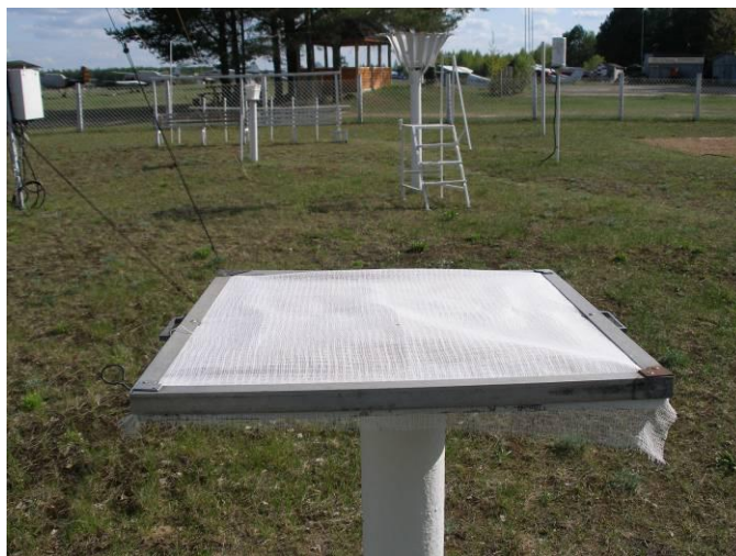
Рис. 1.8 – Установка для отбора твердых выпадений из атмосферы (м/с Тверь)
