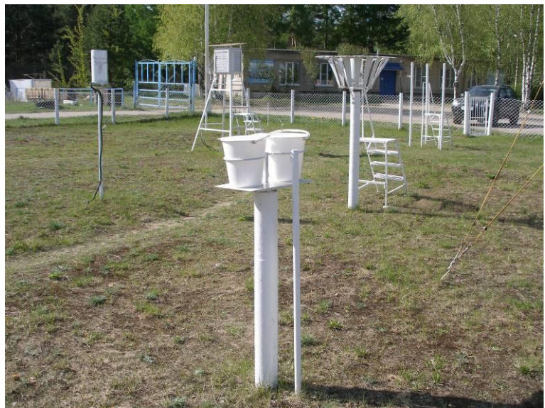
Рис. 1.4 – Установка для сбора атмосферных осадков для определения кислотности и химического состава
