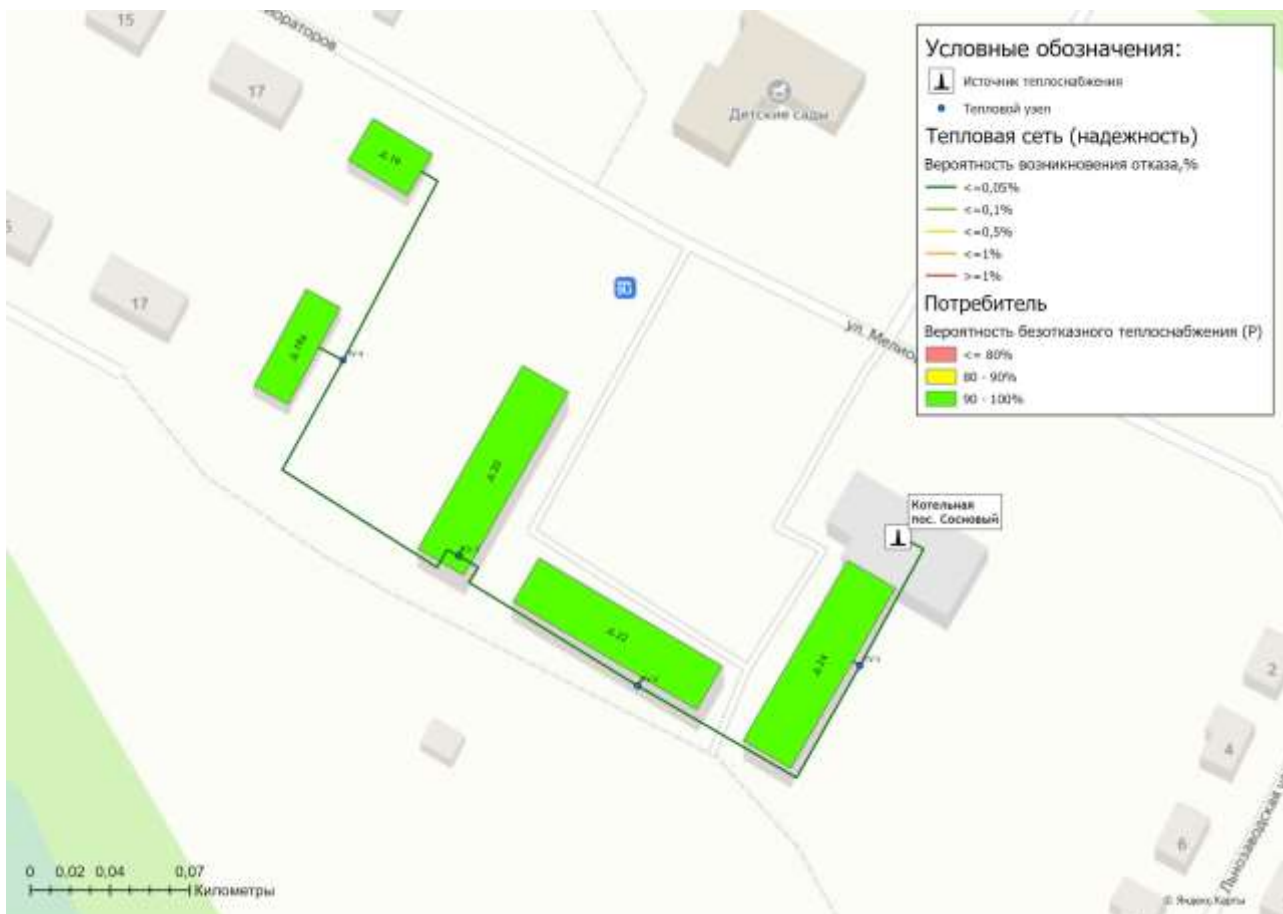
Рисунок 1.9.4.3 - Карта-схемы тепловых сетей и зон ненормативной надежности и безопасности теплоснабжения от котельной "Сосновый" (ул. Молодежная, 24а)
