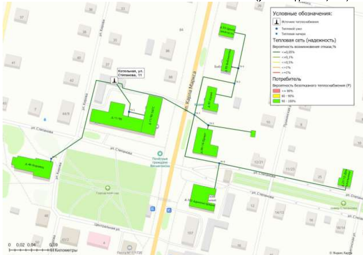
Рисунок 1.9.4.4 - Карта-схемы тепловых сетей и зон ненормативной надежности и безопасности теплоснабжения от котельной ул. Степанова, 11а
