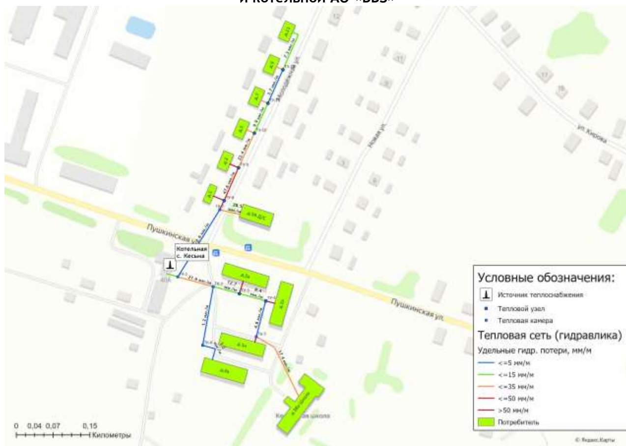
Рисунок 3.4.6 - Гидравлические расчеты участков тепловой сети котельной с. Кесьма ул. Пушкинская, д.40а
