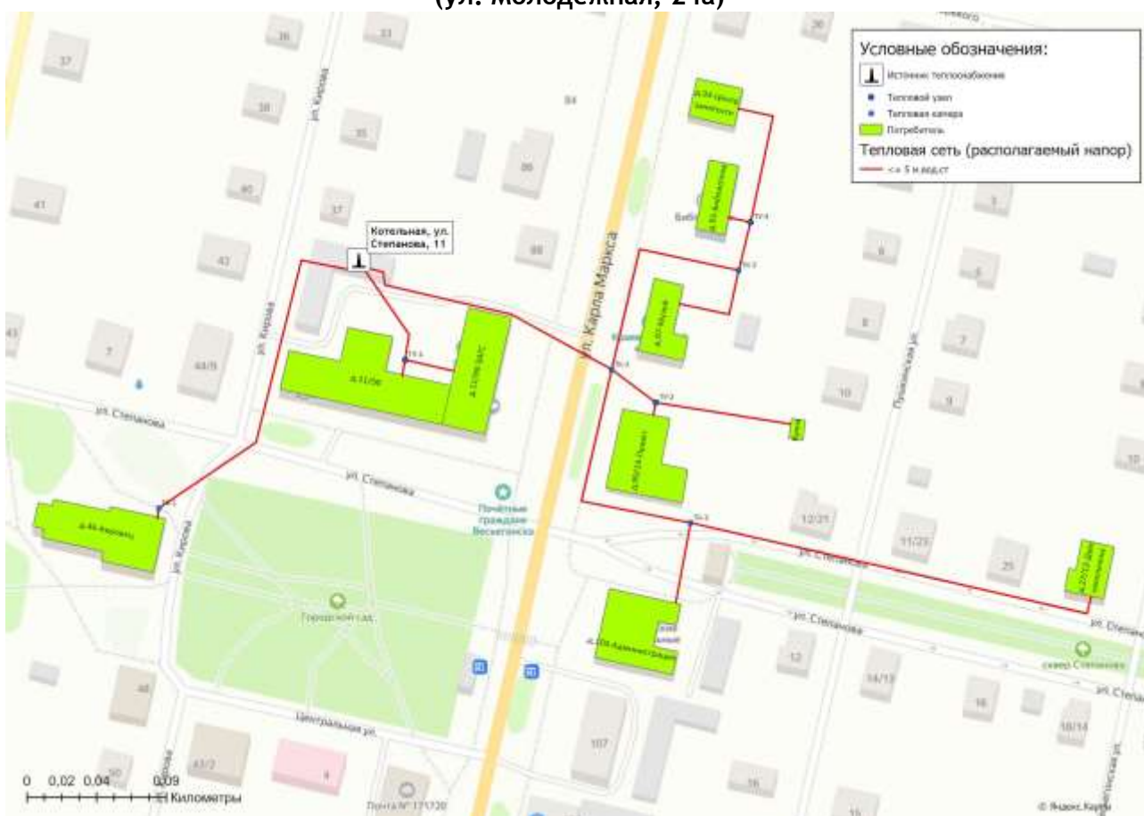
Рисунок 1.6.2.4 - Располагаемый напор на участках тепловых сетей котельной ул. Степанова, 11а
