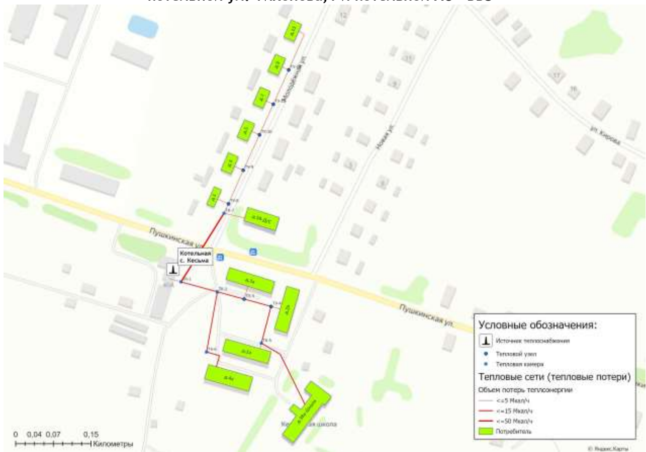
Рисунок 3.7.6 - Потери тепловой энергии при её передаче по участкам тепловых сетей с. Кесыма ул. Пушкинская, д.40а
