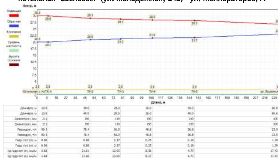
Рисунок 1.3.8.8 - Пьезометрический график участка сети отопления котельная с. Кесьма - Школа (ул. Пушкинская, 38а)
