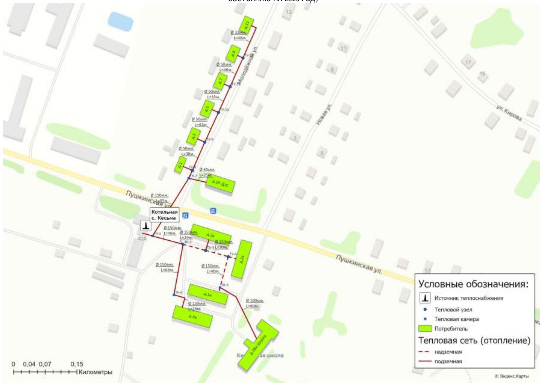
Рисунок 1.3.2.6 - Схема тепловых сетей котельной с. Кесьма ул. Пушкинская, д.40а
